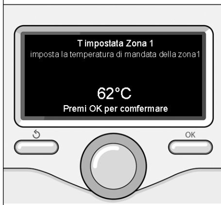
Modifica temperatura acqua calda riscaldamento
